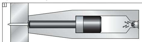
Енергията на заряда се предава на бутало, чиято ускорена маса забива пирона в основата. Тъй като около 95 % от кинетичната енергия остава концентрирана в буталото, крепежният елемент прониква контролирано в основата със силно намалена скорост, по-малка от 100 м/сек. Със застопоряването на буталото в уреда приключва работата и по този начин при правилната му употреба опасните простиранния са практически невъзможни.
