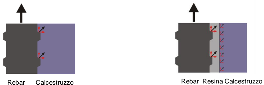
Figura 27 – Meccanismo schematico del trasferimento del carico di un ferro di armatura gettato in opera e post-installato.
