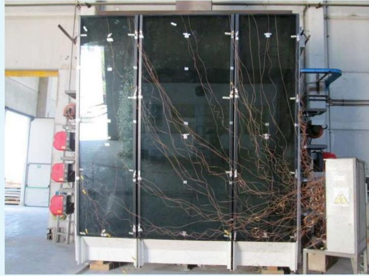
Fotografia della faccia esposta al fuoco del campione dopo la prova. Fotografia della faccia non esposta al fuoco del campione dopo la prova.
