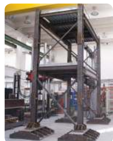
Prova pseudodinamica su un edificio in acciaio di due piani in scala reale (laboratorio StrEngTH)
