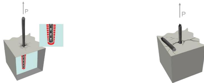
a) Rottura per sfilamento, pull-out
