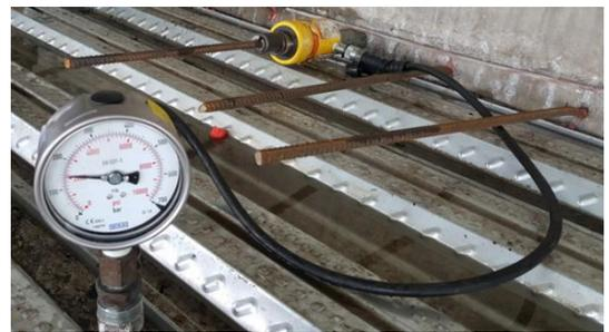
c) Prove di trazione delle armature post-installate
