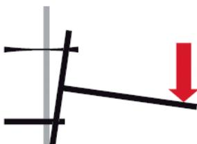
In questo caso si devono utilizzare ancoranti di categoria C2, e la resistenza a cedimento lato acciaio di progetto deve avere il valore minimo.
