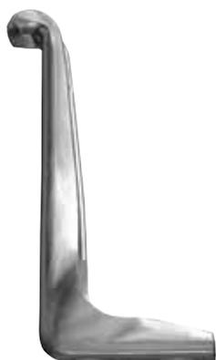
Fornitura e posa in opera di connettori duttili a taglio tipo **Hilti X-HVB** con valutazione ETA e marcatura CE, per la realizzazione di solai collaboranti in acciaio-calcestruzzo. Altezza e interasse dei connettori andranno definiti sulla base delle indicazioni riportate nello specifico progetto. Le caratteristiche meccaniche dei connettori dovranno essere pari o superiori alle seguenti:
