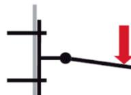
L'ancoraggio deve resistere al carico corrispondente alla capacità degli elementi collegati. In questo caso, il carico impiegato per il calcolo dell'ancoraggio risulta dalla resistenza degli elementi collegati.
