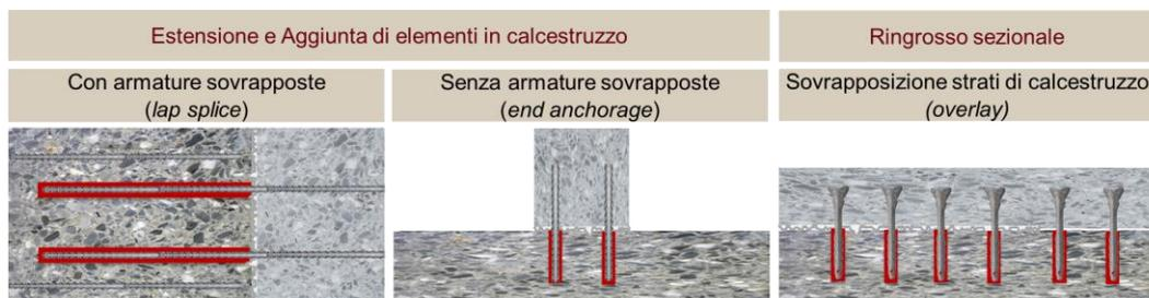
Sia le estensioni e l'aggiunta di elementi nuovi sia i rinforzi tramite sovrapposizione di strati trovano applicazione a livello di impalcato, lungo i pilastri e nelle fondazioni.
