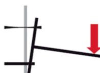
La rottura a trazione lato acciaio dell'ancorante deve essere quella dimensionante e devono essere rispettati i requisiti di comportamento duttile dell'ancorante.
