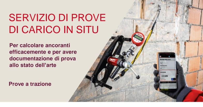
2. Determinazione della resistenza a trazione dell'ancorante in materiale base sconosciuto o incerto, tramite un predefinito carico di prova (test non distruttivi)
