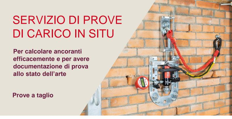
Determinazione della resistenza a taglio dell'ancorante in materiale base sconosciuto o incerto, tramite un predefinito carico di prova (test non distruttivi)
