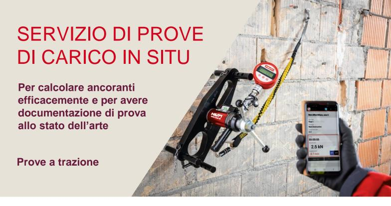
1. Determinazione della resistenza a trazione dell'ancorante in materiale base sconosciuto o incerto, tramite prove a rottura (test distruttivi)
