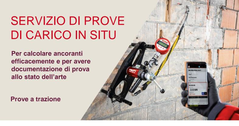
3. Validazione della qualità di installazione degli ancoranti tramite prove a trazione a un predefinito carico di prova (test non distruttivi)
