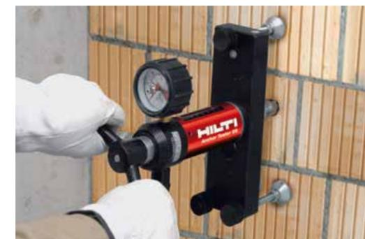
Lo staff professionale Hilti è sempre pronto a eseguire test in cantiere per determinare la resistenza dell'ancorante a iniezione in relazione alla muratura presente.
