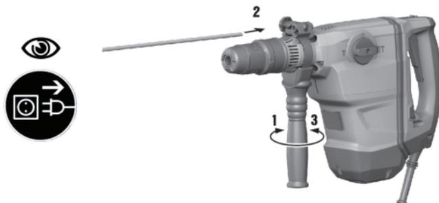
1. Ruotare l'impugnatura per allentare il sostegno (nastro di serraggio) della maniglia laterale.
