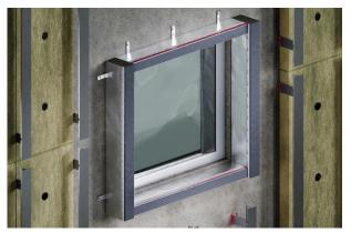
Attorno alle finestre, le cavity barrier non ventilate verticali CFS-NVB devono essere installate su entrambi i lati verticali, estendendosi oltre il lato della finestra sopra e sotto l'apertura. Quelle ventilate CFS-VB, invece, devono essere installate orizzontalmente in alto ed in basso, adiacenti a quelle non ventilate.
