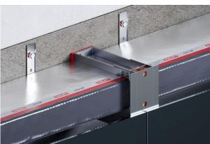
Attendere che la schiuma si espanda. Se la schiuma non è visibile al foro superiore, iniettare più CFS-F FX direttamente dal foro superiore, muovendo l'ugello da un lato all'altro.
