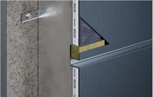
Tagliare una sezione di CFS-NVB che corrisponda allo spessore della barriera verticale e installarla a pressione nel ritorno del pannello a cassetta, assicurandosi che non ci siano spazi.
