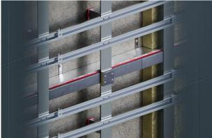
In un sistema a due strati, quando la guida verticale della facciata interseca parzialmente il bordo anteriore della barriera, fissare una sezione di cavity barrier non ventilata CFS-NVB davanti alla guida per assicurarsi che non ci sia spazio tra la guida e il pannello di rivestimento.
