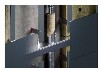
Prevedere un isolamento in lana minerale di 25 mm di spessore attorno al tubo metallico, in modo che l'isolamento si estenda almeno 300 mm sopra e 400 mm sotto la cavity barrier.
