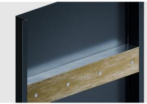
Tagliare una sezione di CFS-NVB in modo che soddisfi le seguenti dimensioni: Altezza: deve estendersi di 10 mm sopra e 10mm sotto la cavity barrier CFS-VB ventilata orizzontale.
