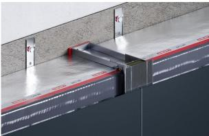
Il pezzo di CFS-NVB dovrebbe estendersi di 20 mm sopra e sotto le cavity barrier ventilate CFS-VB.
