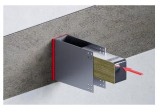
In preparazione dell'installazione del sistema S2S, fissare la staffa a "U" MFT-S2S al bordo della soletta nella posizione di progetto utilizzando ancoraggi Hilti adatti.
