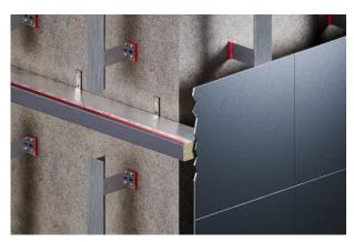
Estendere una cavity barrier CFS-VB oltre l'angolo per tutta la larghezza del vuoto, in modo che il bordo della barriera sia aderente al rivestimento.
